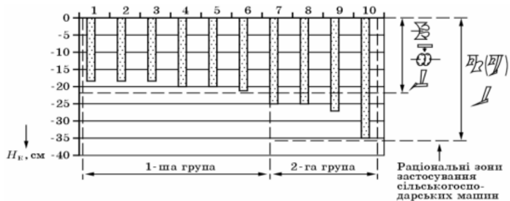
Рис 1.2 Межі раціонального використання машин для основного обробітку залежно від потужності родючого шару ґрунту
