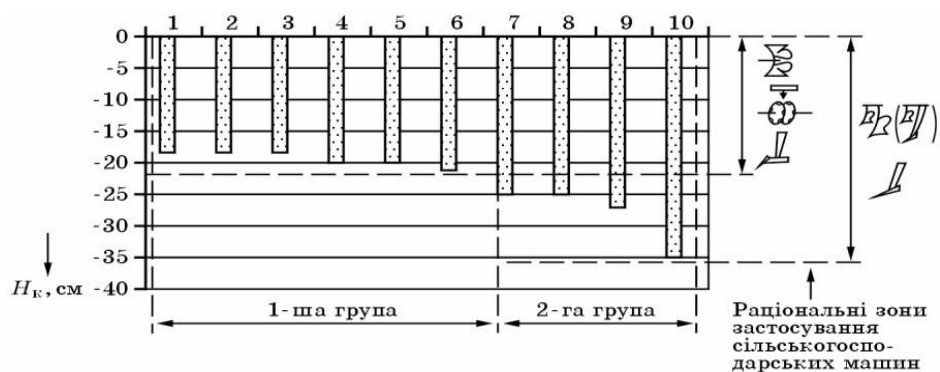
Рис 1.3 Зони використання машин для основного обробітку ґрунту залежно від глибини залягання коренів сільськогосподарських культур.
