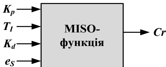
Рисунок 1.2 – Графічне представлення MISO-функції для проведення оптимізації модифікованого ПД-регулятора
