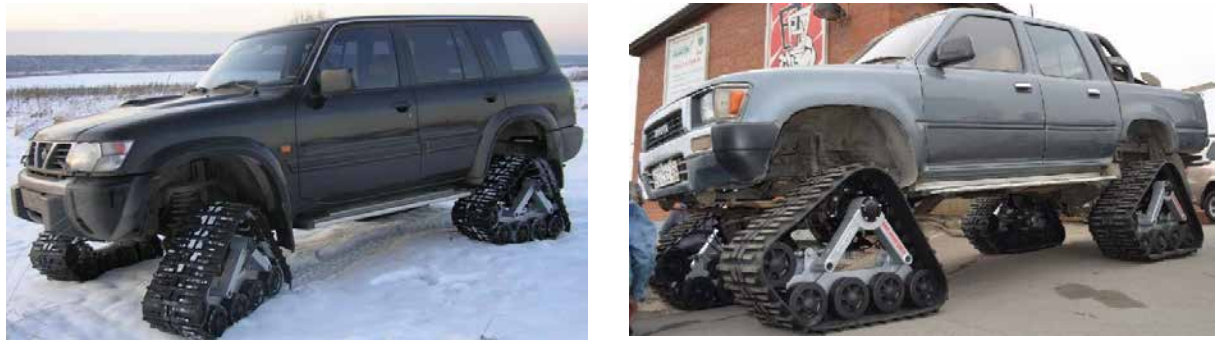
Рисунок 21 – Встановлення гусеничних рушіїв на різні моделі серійних автомобілів
