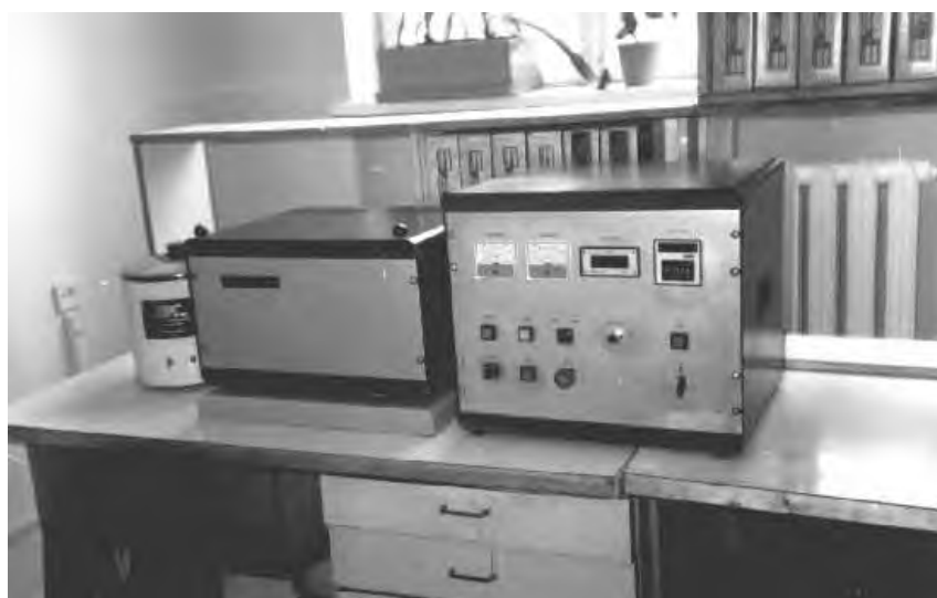
Рис. 1. Прилад для визначення динамічної міцності алмазних порошків типу Фрайтестер.
