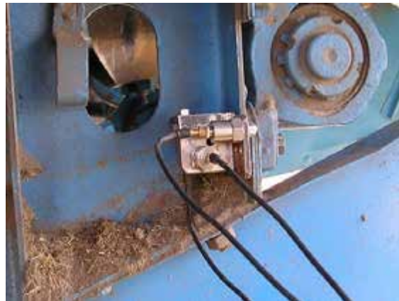
Рис. 2. Вимірювання вібрації болтів зернозбирального комбайна в трьох взаємно перпендикулярних напрямках.
