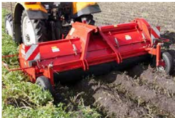
Рис. 3. Бадиллеподрібнювач GRIMME KS 75-4.
