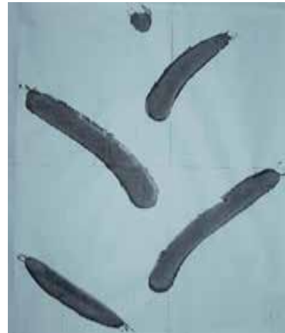
Рис. 3. Схема відбитку контакту шини Firestone Radial 8000 розміру 460/85-18,4R38 при тиску 0,6 кПа та 1,0 кПа.
