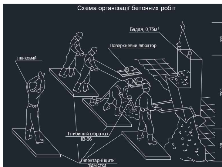
Рис. 4.4. Організація виконання бетонних робіт
