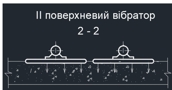
Рис. 4.3. Розміщення вібратора під час ущільнення бетонної суміші
