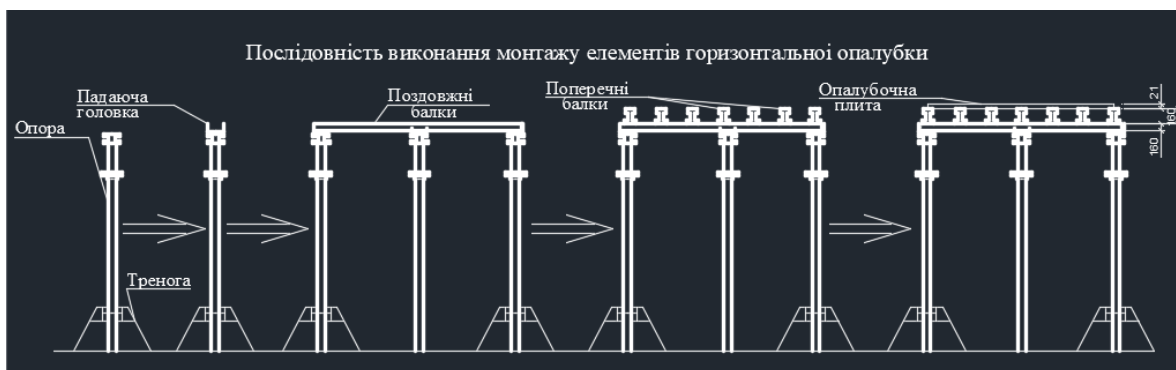
Рис. 4.6. Монтаж елементів горизонтальної опалубки
