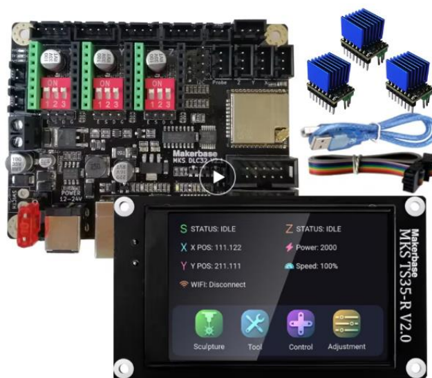
Рис. 2.6. 32-бітний автономний контролер керування ЧПК Makerbase MKS DLC32 v2.1 з Wi-Fi та сенсорним дисплеєм TS35-R [34].
