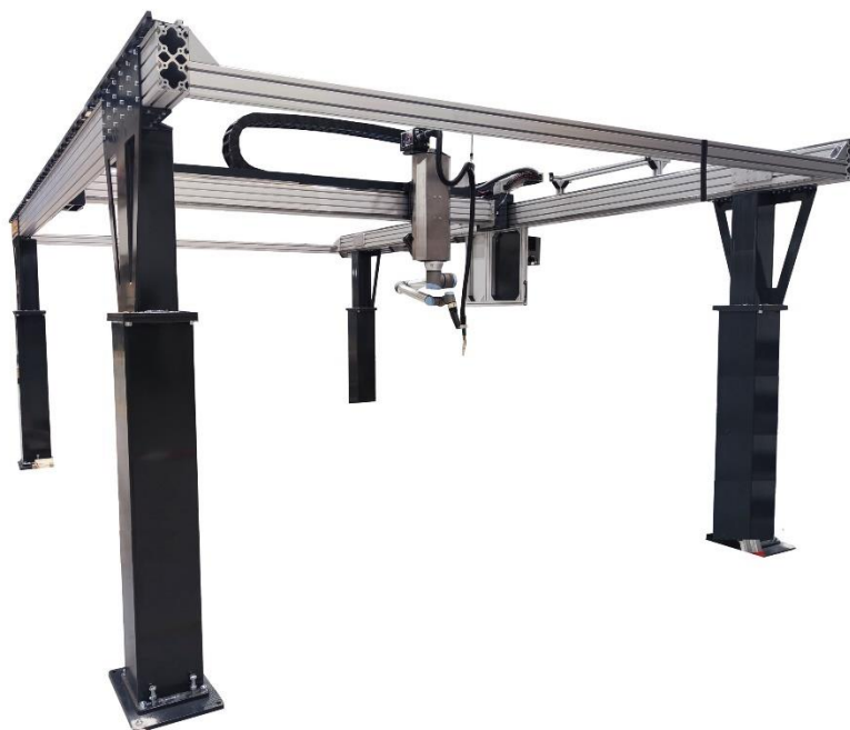
Рис. 1.8. Портал типу «4-Gantry» [19].
