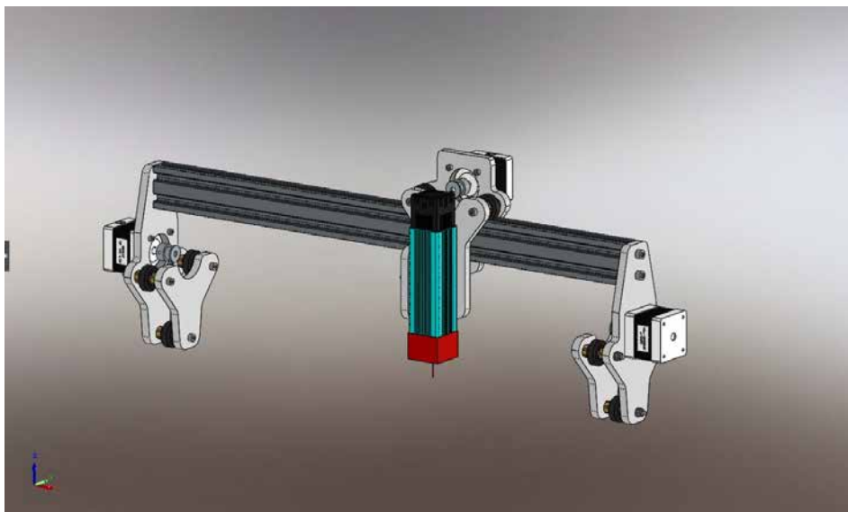
Рис. 2.4. Каретка з лазером закріплена на порталі
