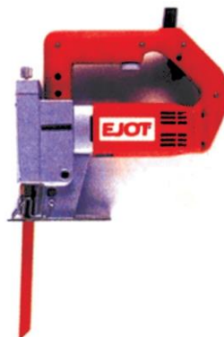
Рис. 5.15. Обертова пилка з дрібнозубчастим полотном
