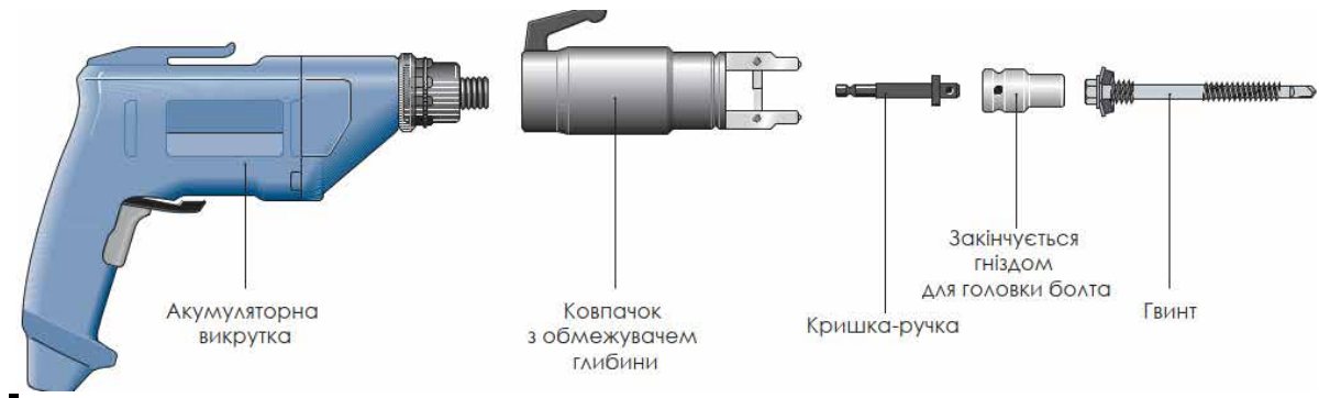
Рис. 5.10. Викрутка, оснащена головкою для закручування довгих з'єднувальних елементів з регулюванням глибини
