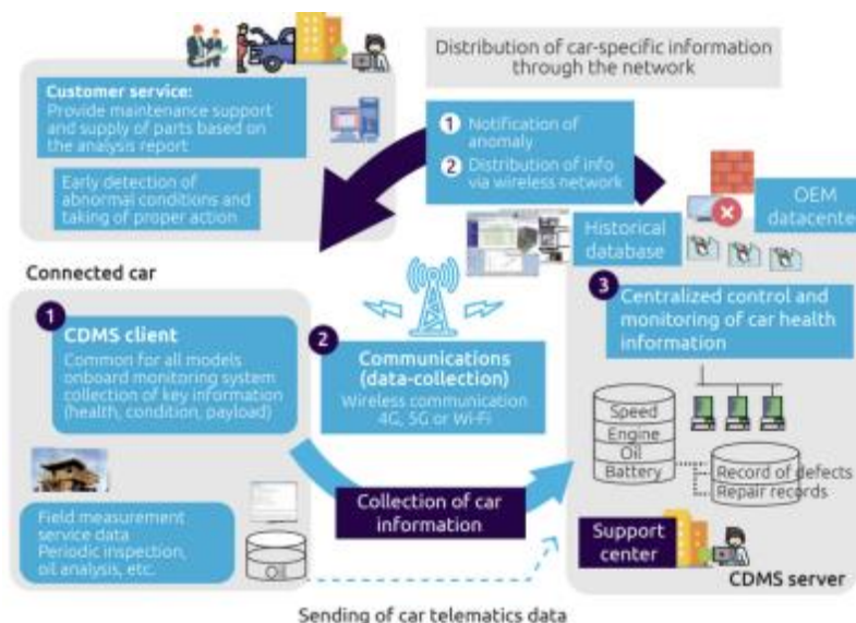
Рисунок 2 – Схема сервісного обслуговування техніки з використанням телематичної системи CMDS
