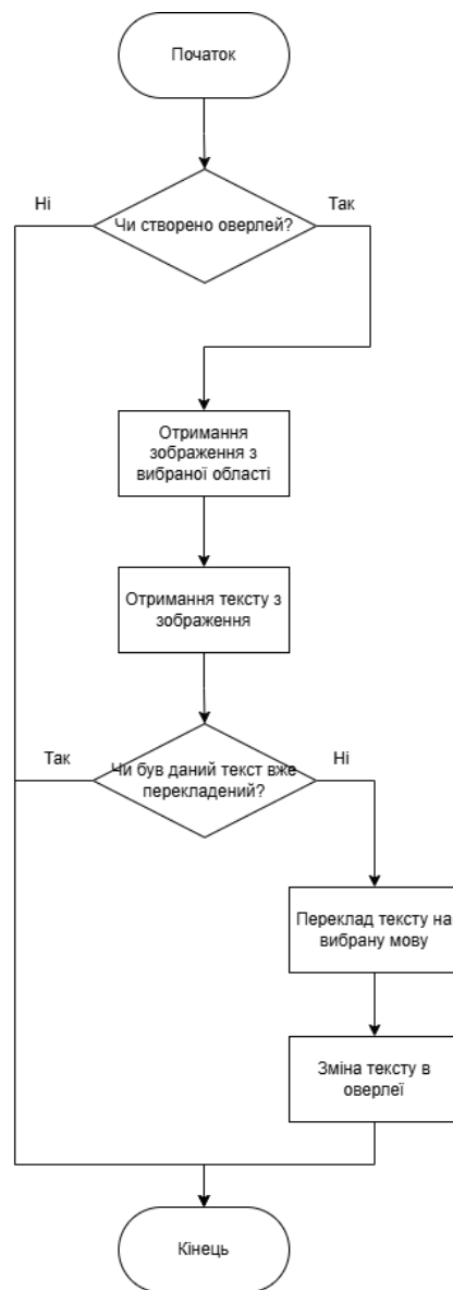
Рис. 16 Блок-схема алгоритму перекладу тексту з екрану
