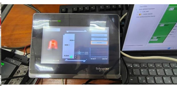
Рис. 7.6 Підключення NMIST6400 на макеті
