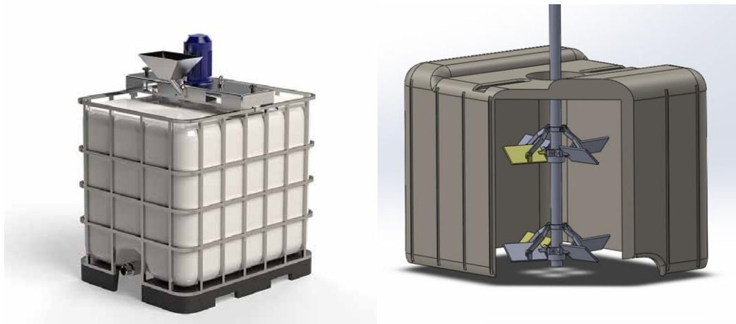
Рис. 1.3. Технологічні резервуари: а) для зберігання колоїдних розчинів; б) змішувач.
