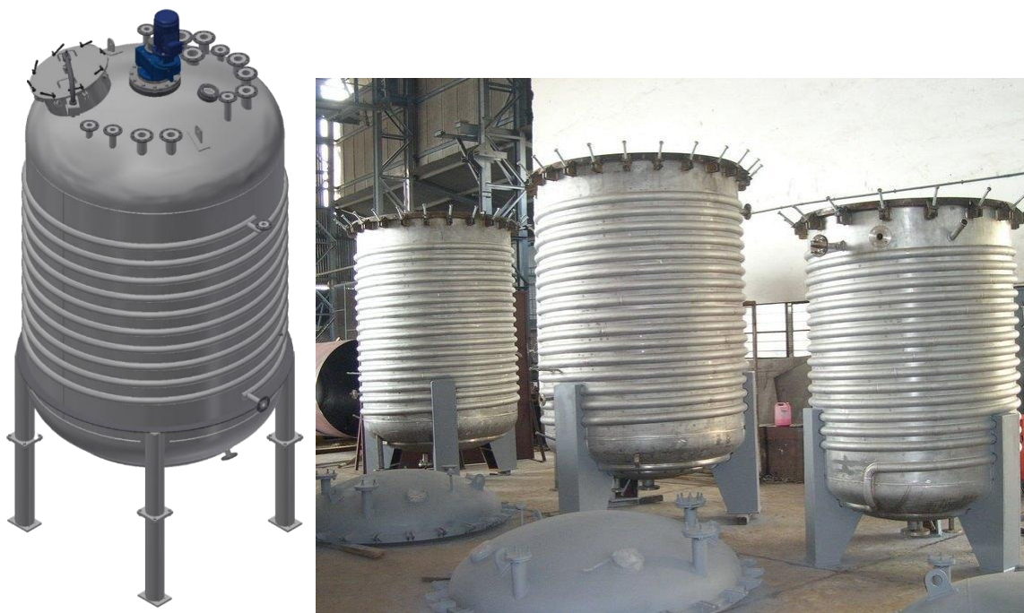
Рис. 1.17. Зображення спіральних сорочок на технологічних резервуарах
