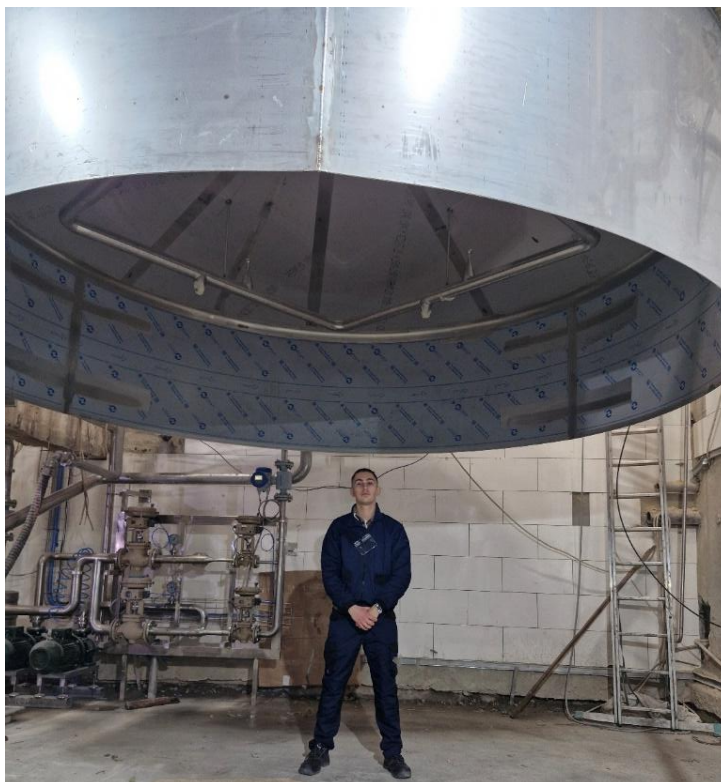
Рис. 1.4. Технологічний циліндричний резервуар в етапі розробки
