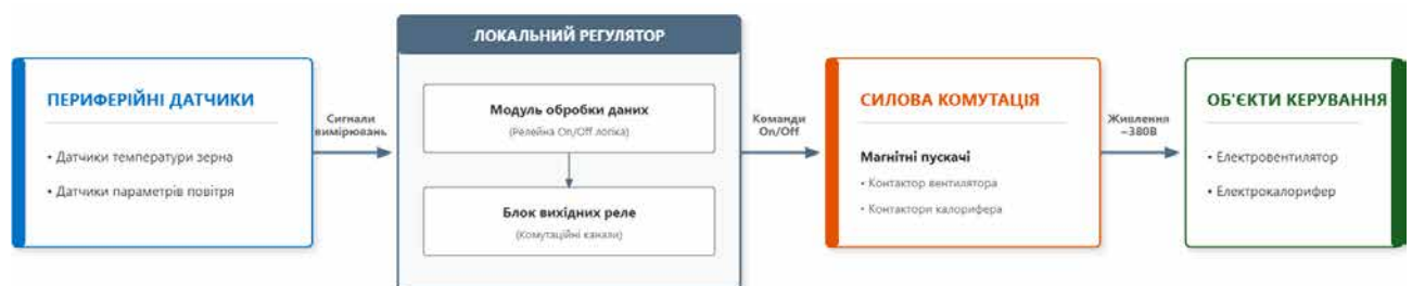
РИСУНОК 1.8 – Структурна схема типової локальної САК вентиляванням на базі двопозиційного мікропроцесорного регулятора
