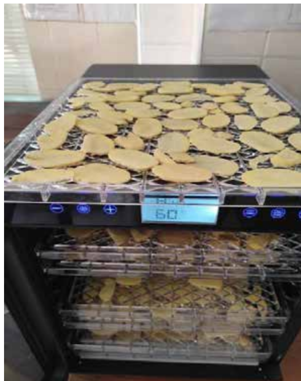
Рис. 2.6. Підготовлені до сушіння бульби та сушарки DEXDFD-510P, використана в дослідженнях
