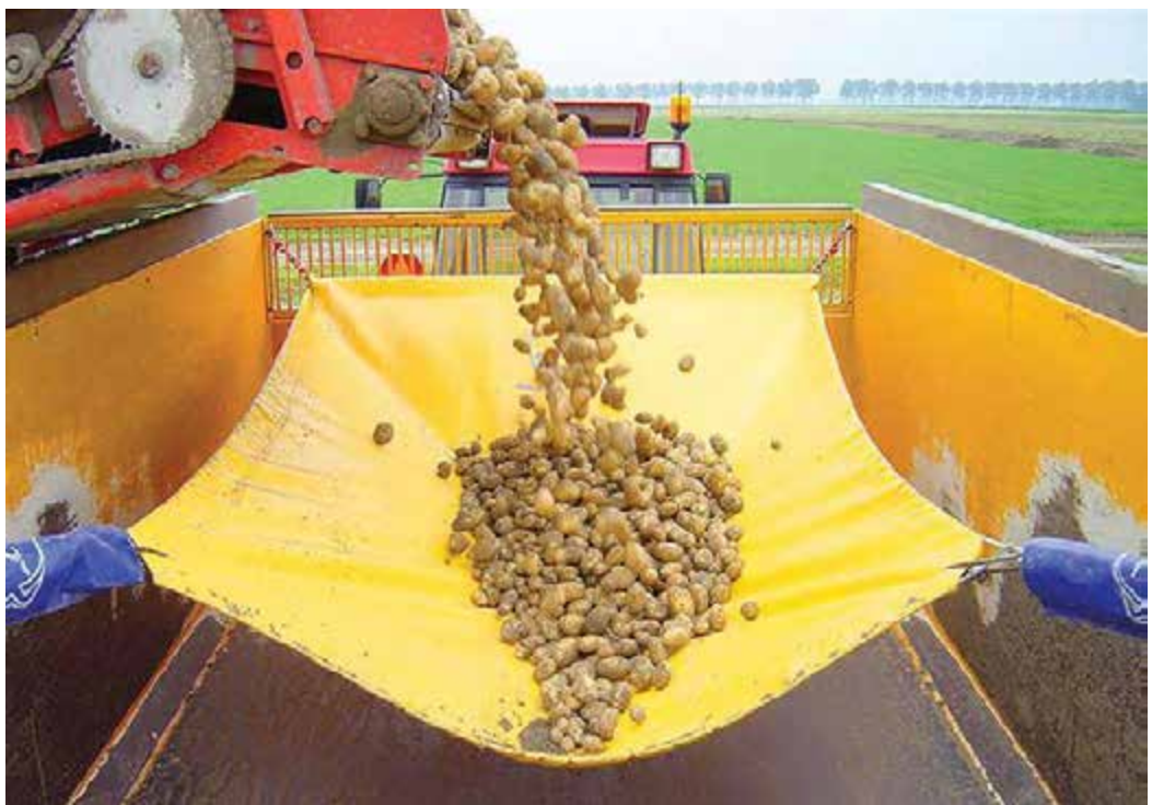
Рис. 1.2. Використання «гасників» удару для запобігання травмування бульб картоплі під час їх збирання
