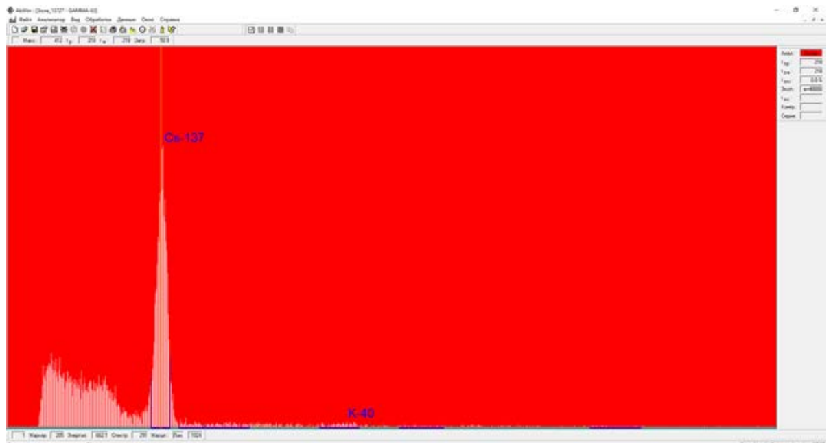
Рис. 3.5. Спектр гамма-випромінювання зразка золи
