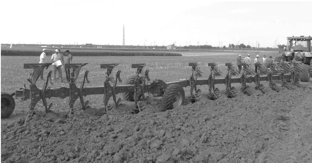
Рис. 1.7 Плуг оборотний з гідравлічним механізмом обертання
