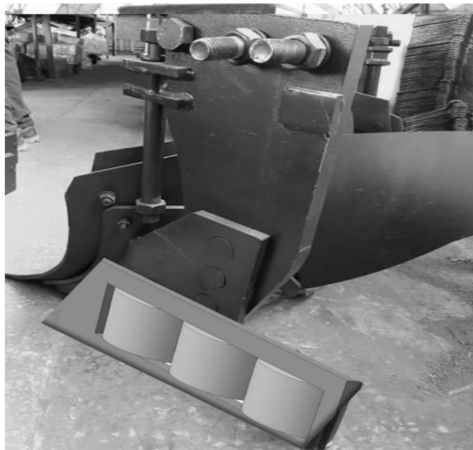
Рис. 2.10. Розміщення роликівими польової дошки на корпусі плуга.
