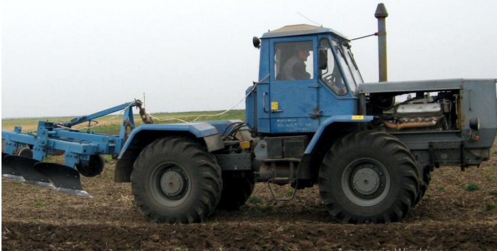
Рис. 2.9. Трактор ХТЗ-170 з плугом ПЛН-3-35,обладнаним роликівими текроновими польовими дошками.
