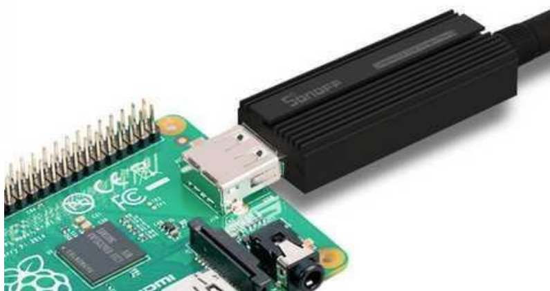
Рисунок 2.11 – Підключення ZigBee адаптеру до міні-ПК Raspberry Pi
