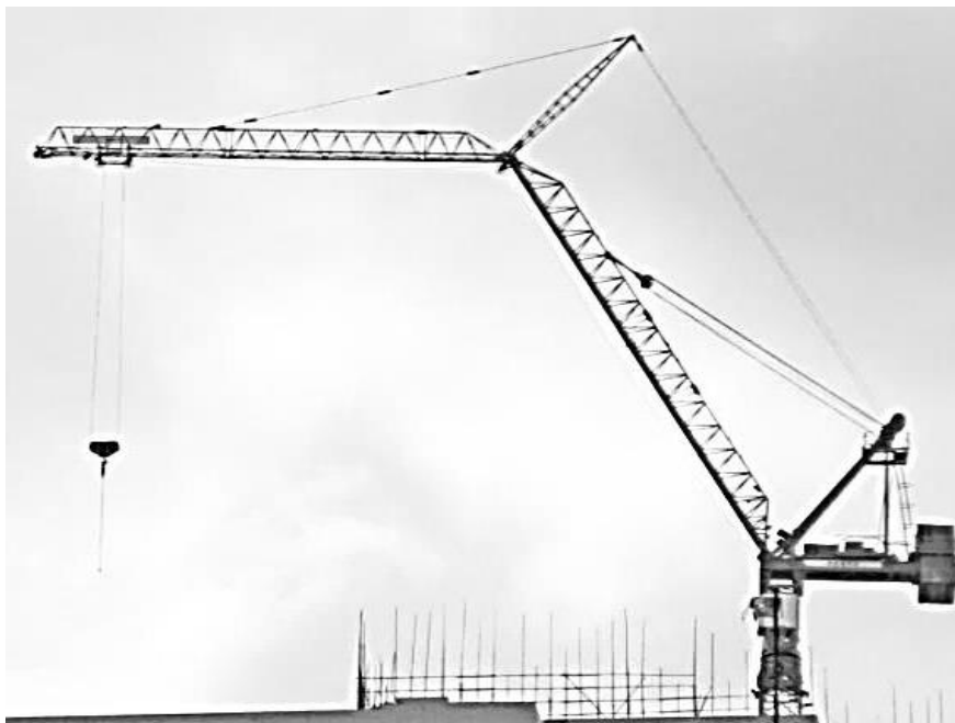
Рис. 1.2. Кран баштовий із стріловою системою шарнірно-зчленованою типу
