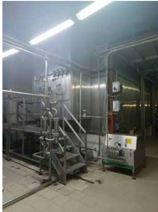
Рис. 1.5. Установа для сушіння яєчних продуктів підприємства «Овостар-Люкс»
