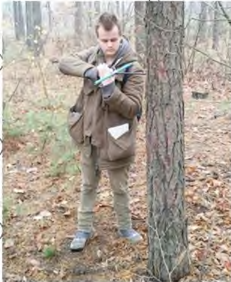
Рис. 4.2. Процес взяття керну ростучого дерева
