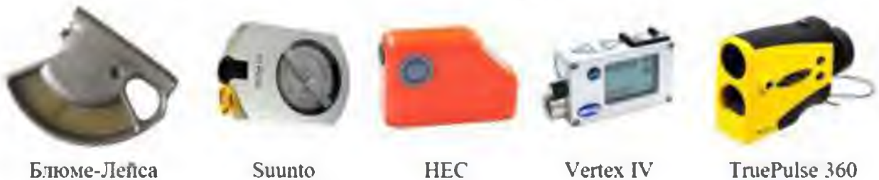
Рис. 4.3. Механічні та електронні висотоміри тригонометричного принципу дії
