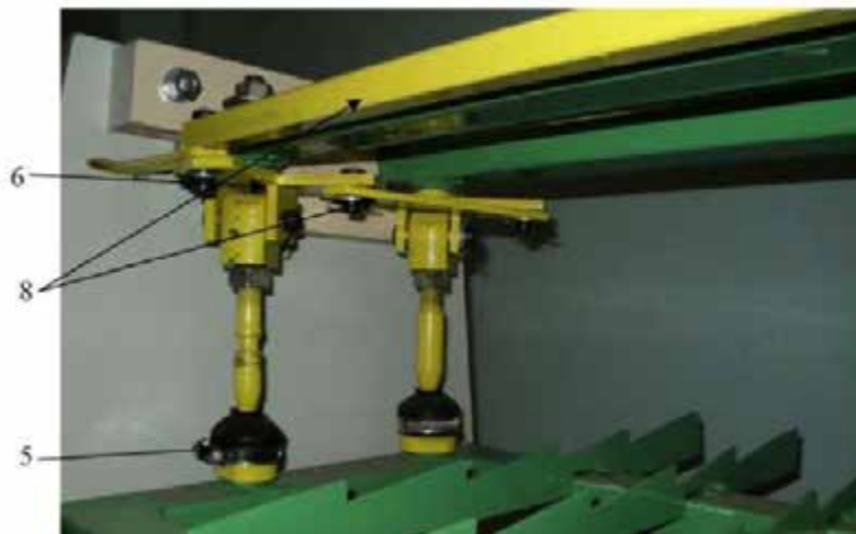
Рис. 5.6 - Дослідний зразок адаптера для схилів: а - загальний вигляд; б - підвіска адаптера
