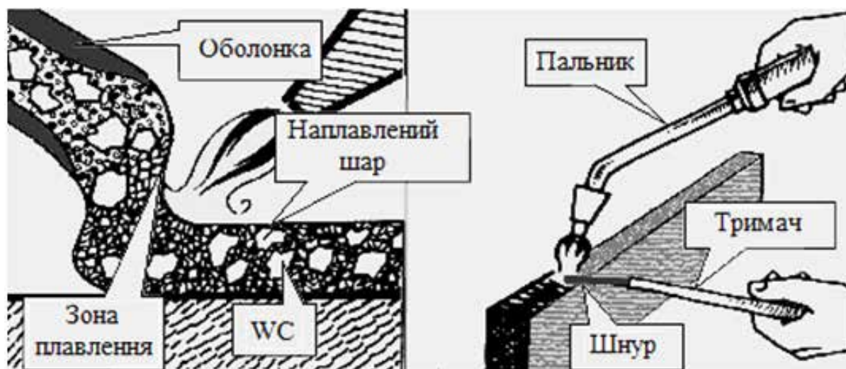
Рис . 3.8 Технологія "Сфекорд-NR" ручного газополум'яного зварювання кордного матеріалу
