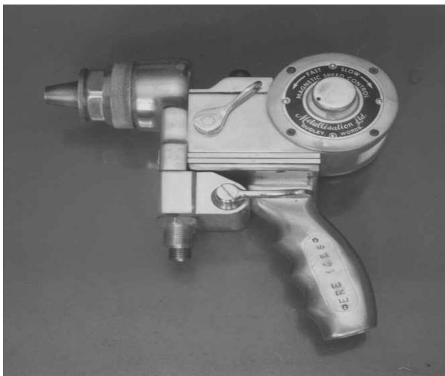
Рис. 3.9 Газополум'яний металізатор МК-40
