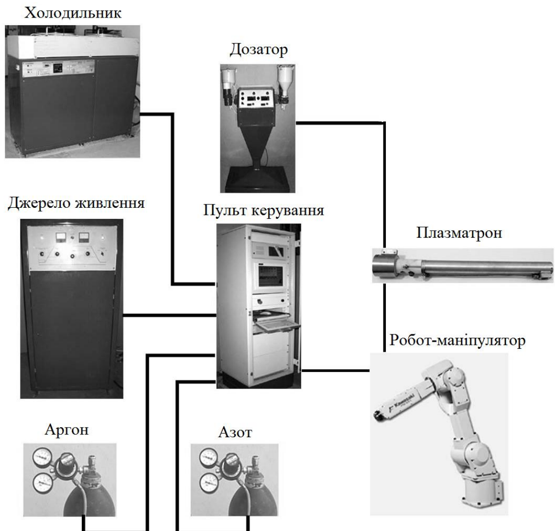
Рис. 3.10. Система плазмового напилення РПН-35
