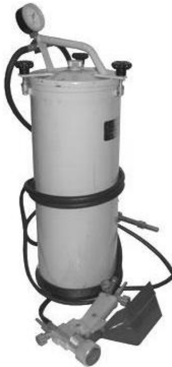
Рис. 3.1. Система порошкового напилення газополум'яного типу для роботи з пропан-бутаном UGPL-P.
