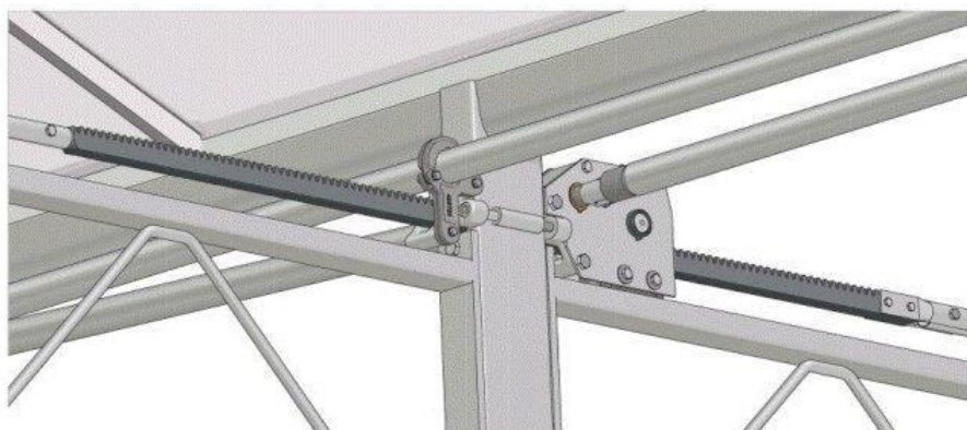
Рис. 3.25. Загальний вид рейкового приводу системи вентиляції в теплиці
