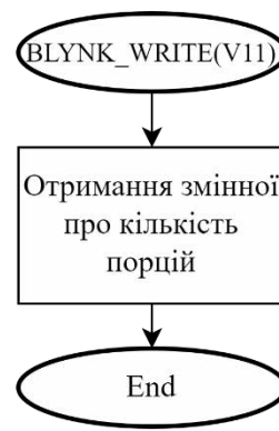
Рисунок 2.22 – Блок-схема з функцією BLYNK_WRITE(V11)
