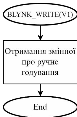
Рисунок 2.20 – Блок-схема з функцією BLYNK_WRITE(V1)
