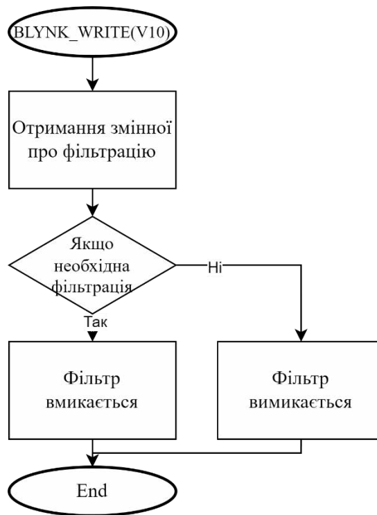
Рисунок 2.15 – Блок-схема з функцією BLYNK_WRITE(V10)
