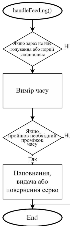
Рисунок 2.24 – Блок-схема з функцією handleFeeding()
