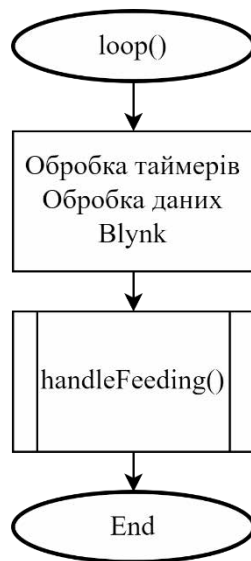
Рисунок 2.12 – Блок-схема з функцією loop()
