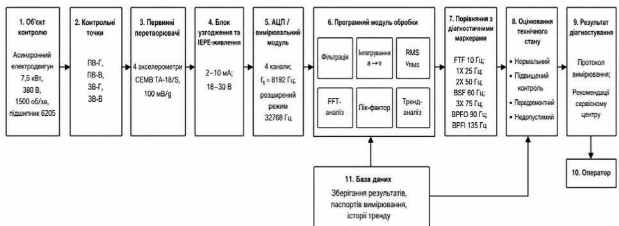
Рис. 3.1 Структурна схема вібродіагностичної системи електричних машин
