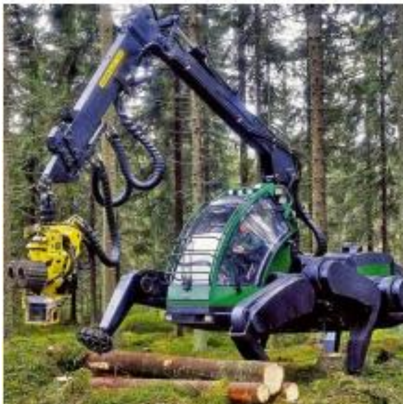
Рис. 1.4. Крокуючий робот маніпулятор Walking forest machine компанії Джон Дір
