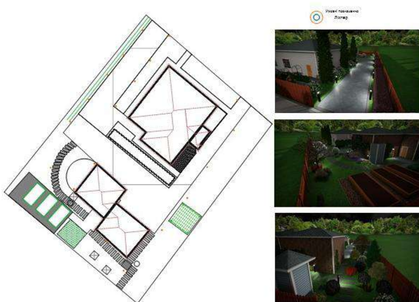
Рис. Б.2. Схема системи освітлення (розроблено автором)
