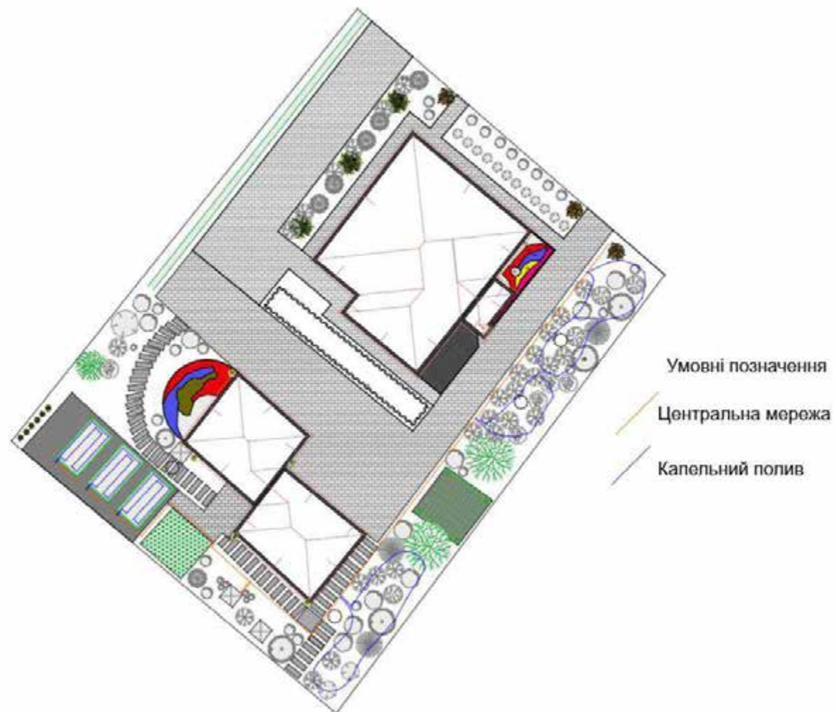
Рис. Б.3. Схема системи крапельного поливу (розроблено автором)
