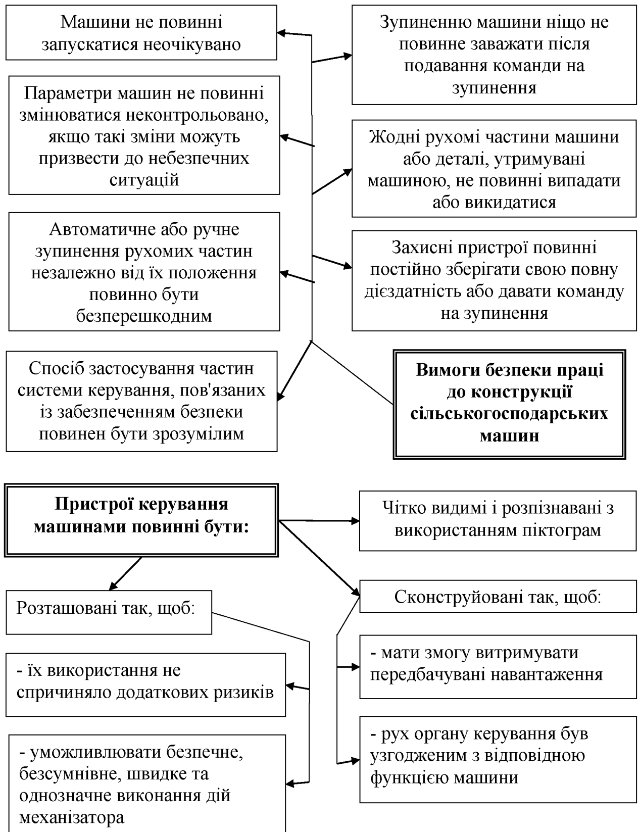
Рис. 5.1. Вимоги безпеки праці щодо конструкції збиральних сільськогосподарських машин та пристроїв керування ними
