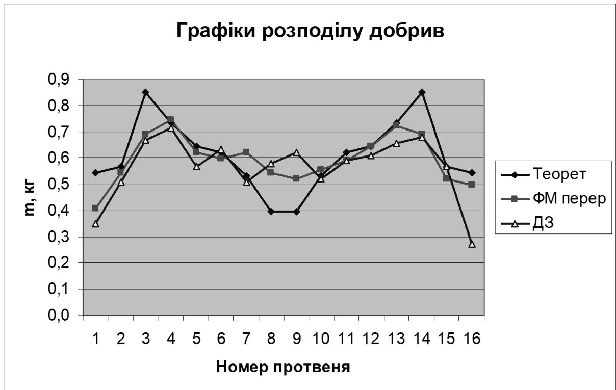
Рис. 4.24. Графіки розподілу добрив розкидальним барабаном з 2-ма чвертьеліпсними і 4-ма півеліпсними розподілювачами
