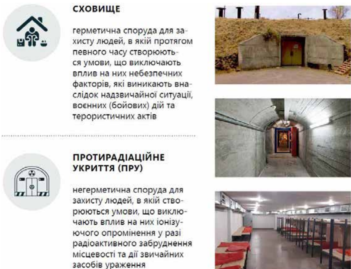
Рисунок 1 – Підземні захисні споруди цивільного захисту [2].
