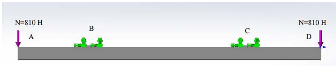
Рис. 3.5. Схема розташування точок прикладання сили (навантаження) та закріплення балки в Simulation Express
