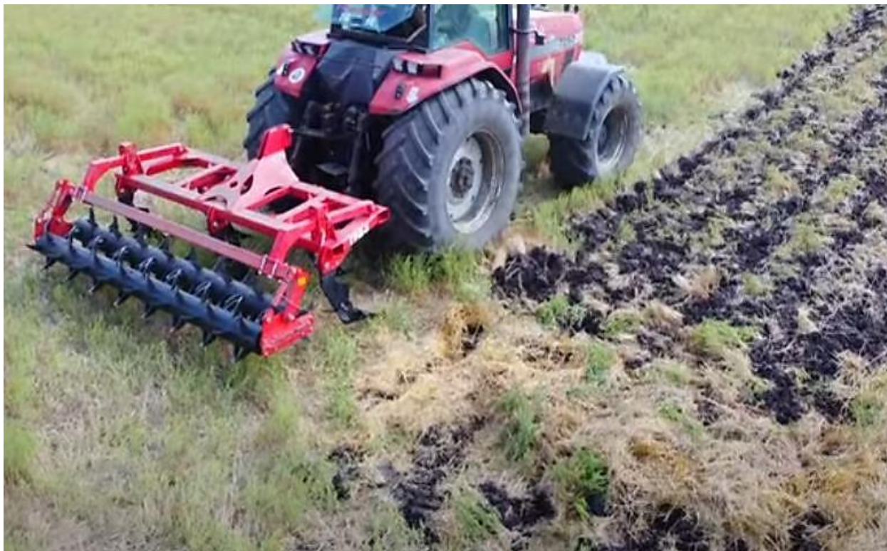
Рис. 2.6. Глибокорозпушувач ГРД-5 та накопичення рослинних решток в кінці загінки
