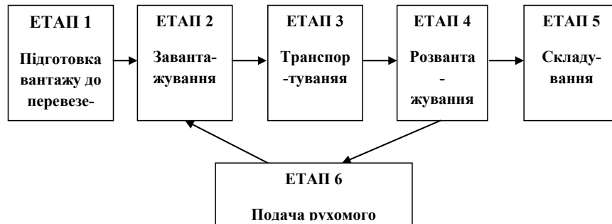
Рис. 3.4. Схема технології перевезення вантажів автопідприємством «Вантажоперевезення-24»
