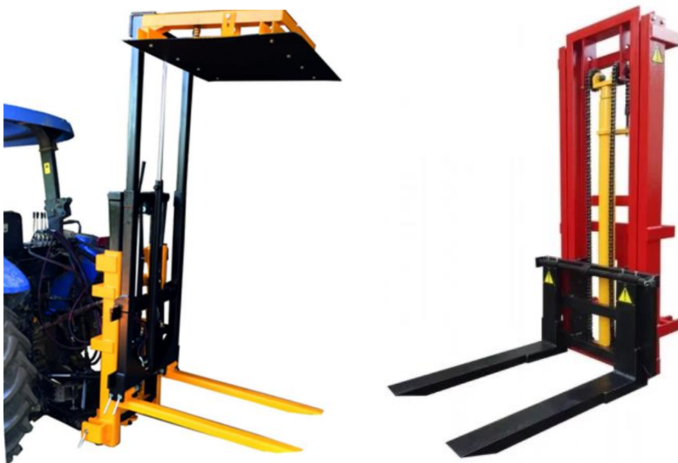
Рис.10.2. Вилчасті начіпні на трактор навантажувач: а – навантажувач Macfruit Export 3000; б – навантажувач НВП–700
