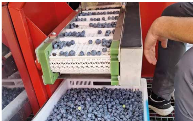
Рис. 9.21. Сортування та очищення від сміття в комбайні KAREN
