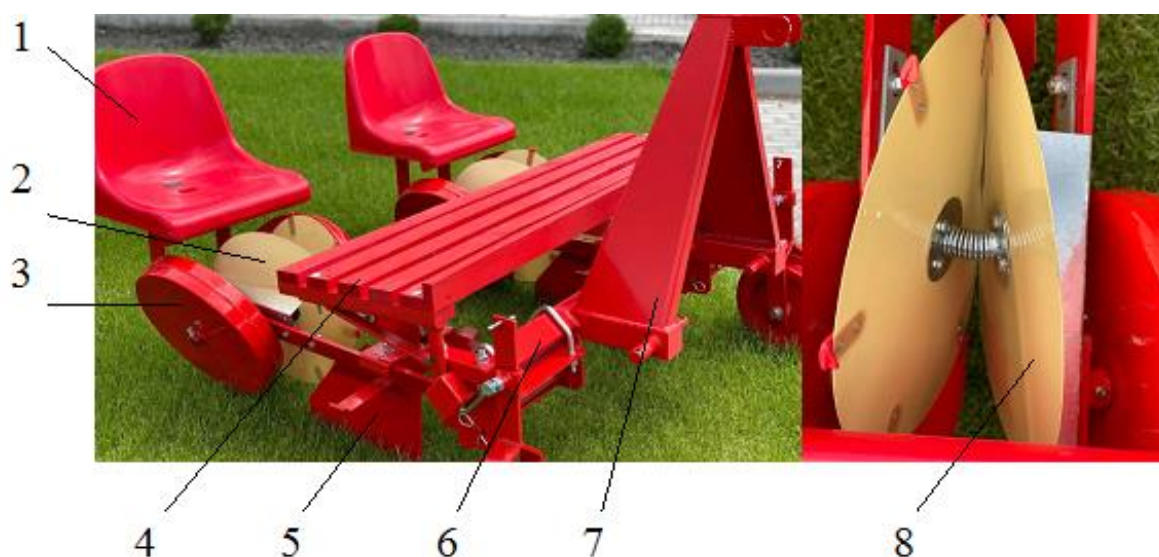
Рис. 11.9. Дворядна розсадосадильна машина: 1 – сидіння; 2 і 8 – садильні диски; 3 – прикочувальні котки; 4 – площадка для посадкового матеріалу; 5 – сошники; 6 – рама; 7 – автозчіпка
