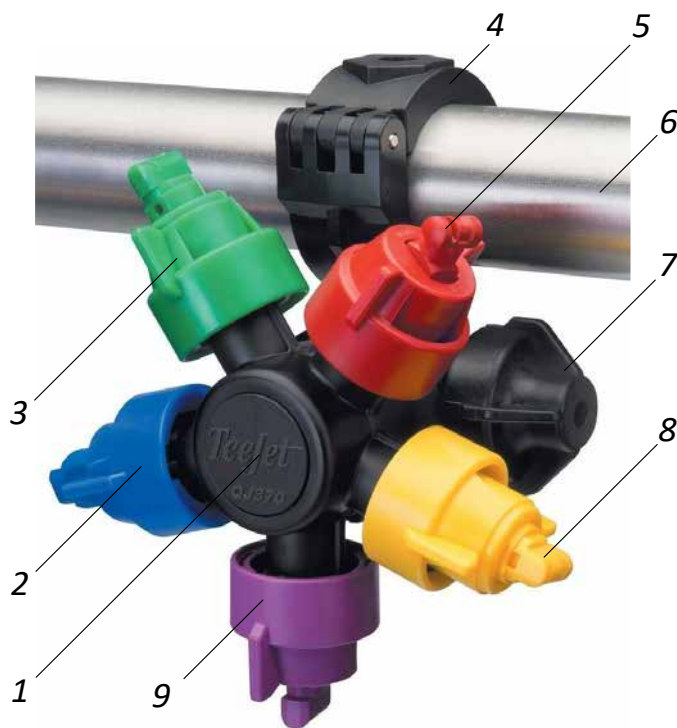
Рис. 6.5. Багатопозиційна головка з розпилювачами: 1 – корпус; 2, 3, 5, 8, 9 – розпилювачі; 4 - кронштейн кріплення до штанги; 6 – штанга; 7 – клапан-відсікач
