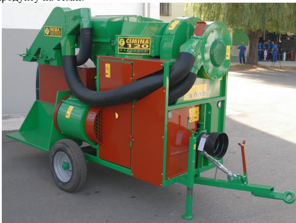
Рис. 9.27. Причипний комбайн CIMINA 120
