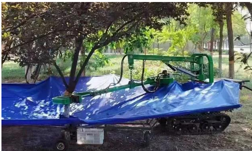
Рис. 9.6. Схема струшувача з кривошипно-штангним механізмом постійного зміщення
