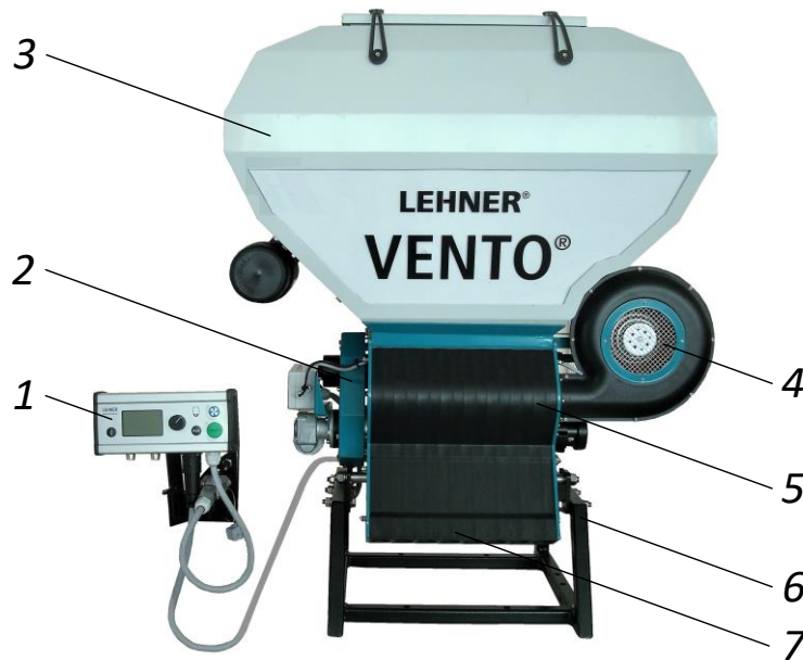
Рис. 4.15. Загальний вигляд пневматичного висівного модуля Vento II, вид спереду: 1 – пульт керування; 2 - пневматичний висівний апарат; 3 – бункер; 4 – вентилятор; 5 – котушкова камера; 6 – універсальне кріплення; 7 – висівні канали (вісім отворів).
