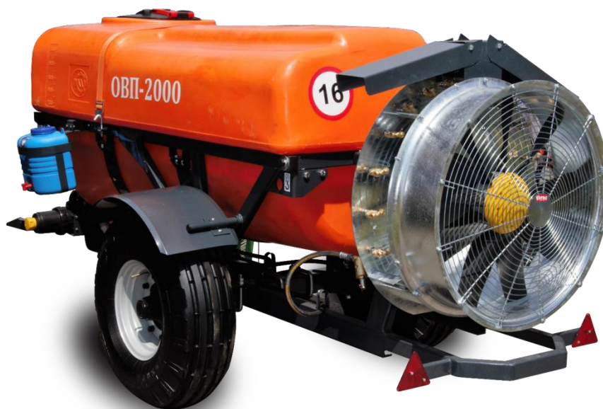
Рис.6.8. Загальний вигляд обприскувача ОВП – 2000 з осьовим вентилятором
