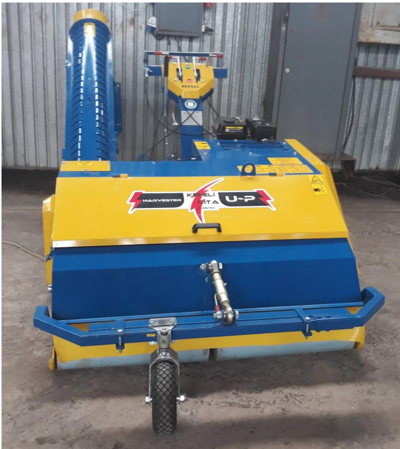
Рис. 9.26. Машини для збирання горіхів: а) – подвійна садова гідравлічна щітка Unic 301 ; б) – горіхозбиральний комбайн Unic 1300
