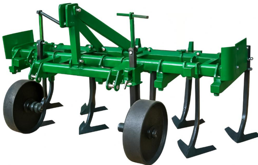
Рис. 5.5. Культиватор-розпушувач начіпний ПРВМ-3: 1 – рама; 2 – 3 х точкової начіпки; 3 – опорні колеса; 4 – гвинтові механізми; 5 – робочі органи
