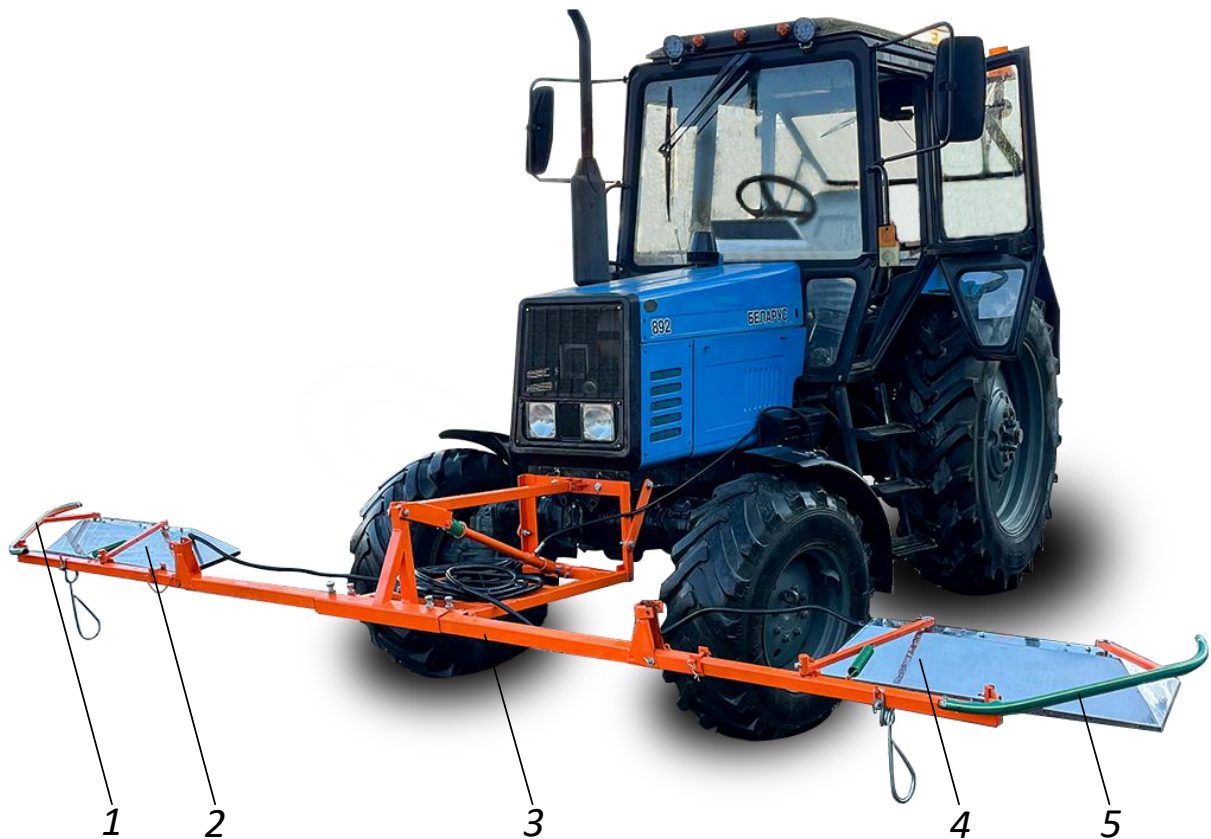
Рис. 5.29. Обприскувач ЗУБР НШГ/ДС-2: 1, 5 – щупи гідрослідкувального пристрою; 2, 4 – секції з розпилювачами; 3 – штанга з регульованою шириною захвату
