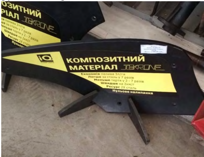
Рис. 1. Відвал плуга, виготовлений з високомолекулярної сполуки “TEKRONE”
