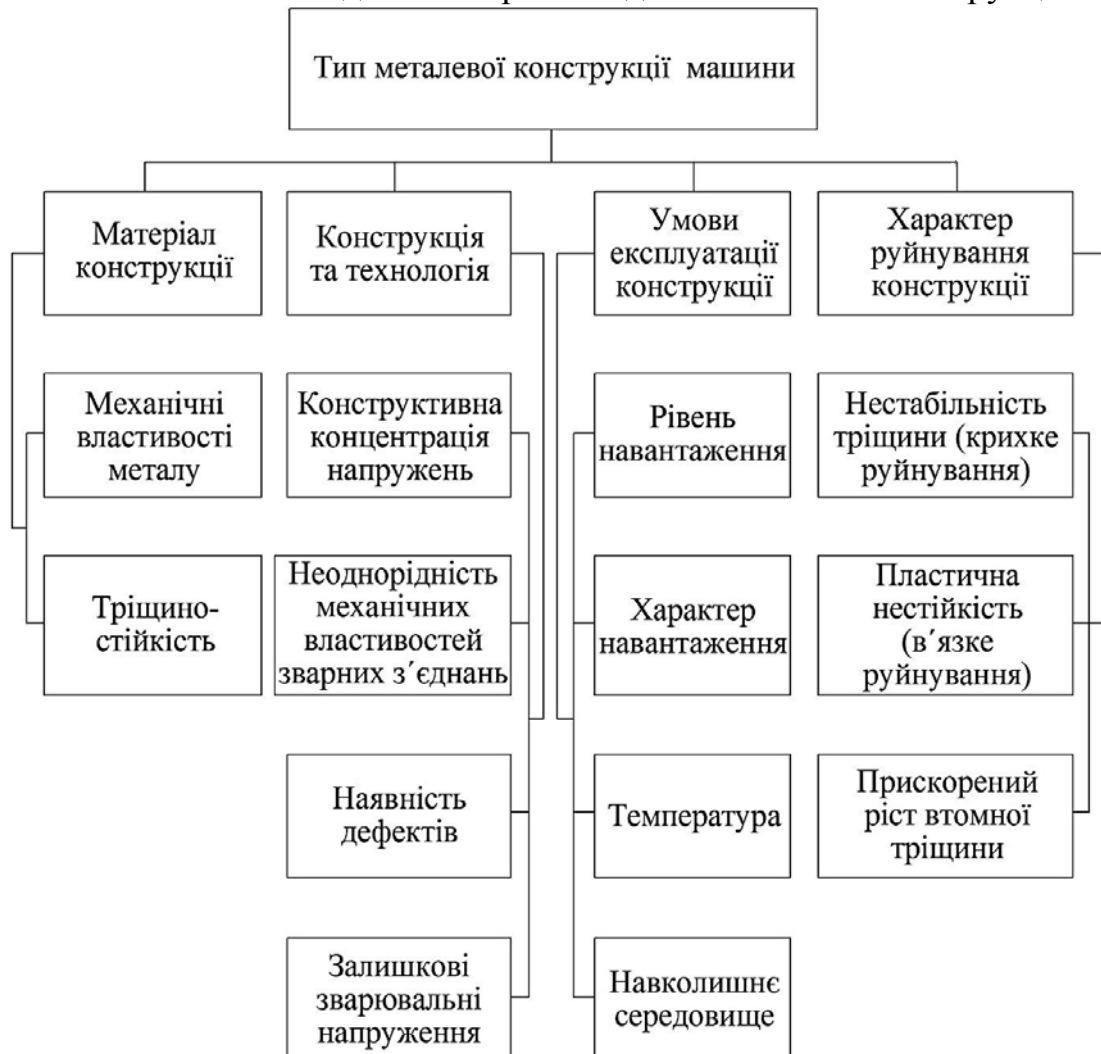
Рис. 1. Фактори, що визначають можливість настання граничного стану руйнування зварних металевих конструкцій машин
