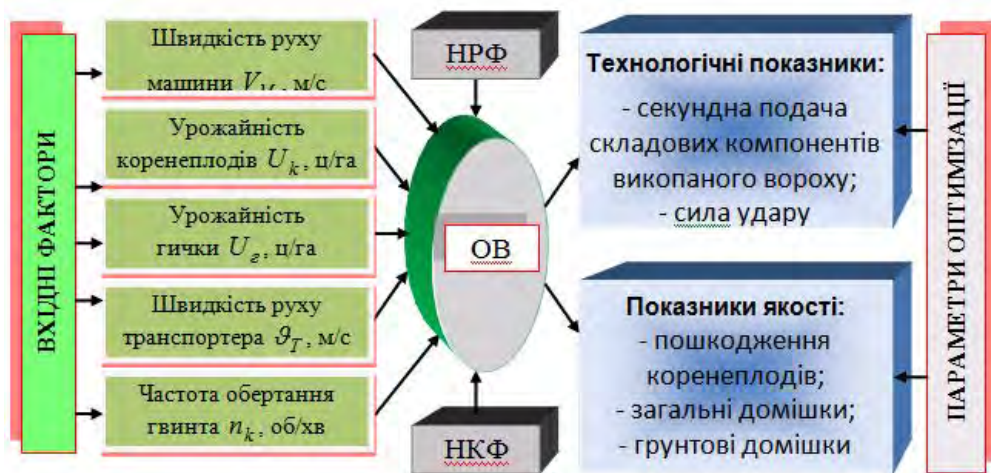
Рис. 1. Структурна модель проведення експериментальних досліджень очисника вороху з комбінованим робочим органом
