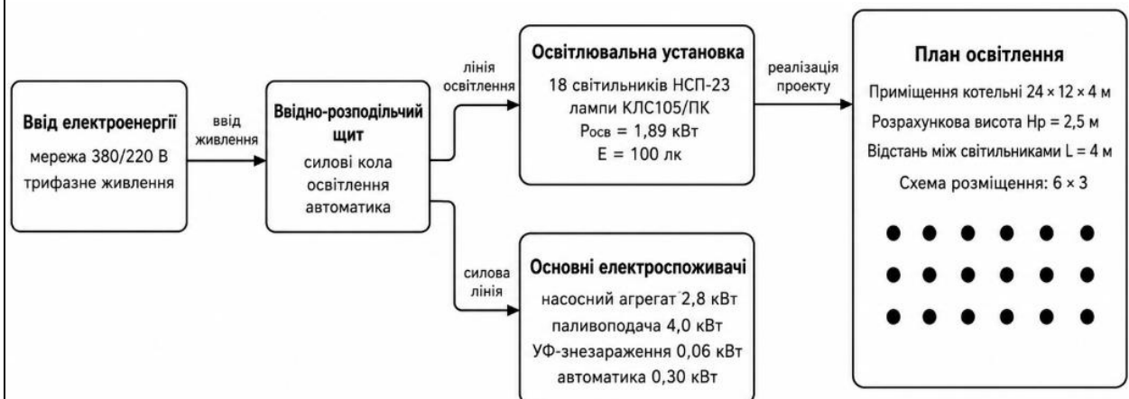
Рисунок 3.1 – Схема аналізу електроспоживання та проектування освітлювальної установки котельні
