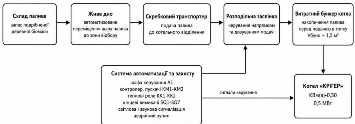
Рисунок Г.1 – Схема модернізації системи подачі та транспортування біопалива
