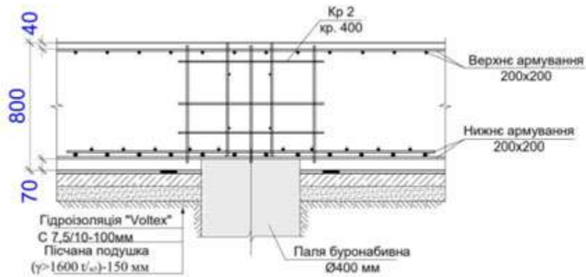
Рис. 2.12. Шарнірний вузел зєднання паль та плитного ростверку
