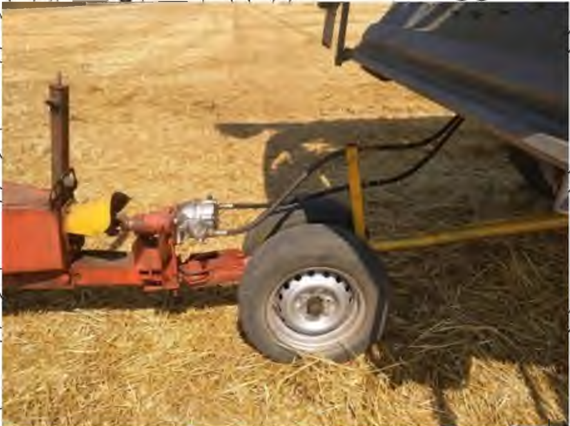
Рисунок 3.2 - Зчеплення до комбайна TORUM-740 для агрегування прес-підбирача ПРФ-180
