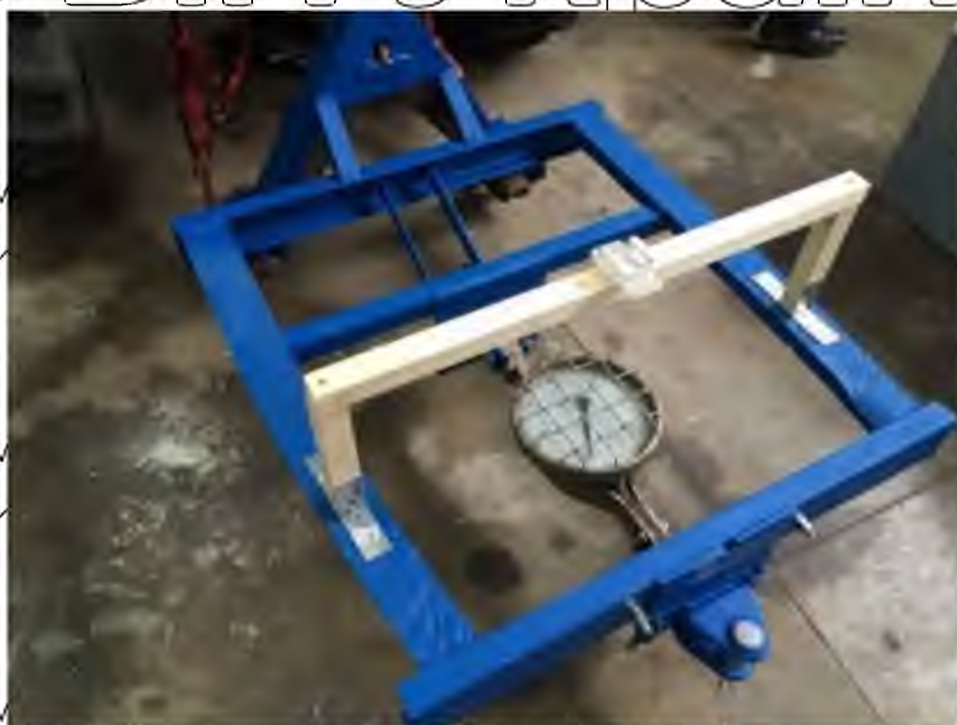
Рисунок 3.4 – Загальний вигляд експериментальної установки для динамометрування прес-підбирача ПРФ-180
