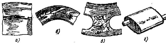
Рис. 1.11 Приклади роз'їдання поверхонь:
