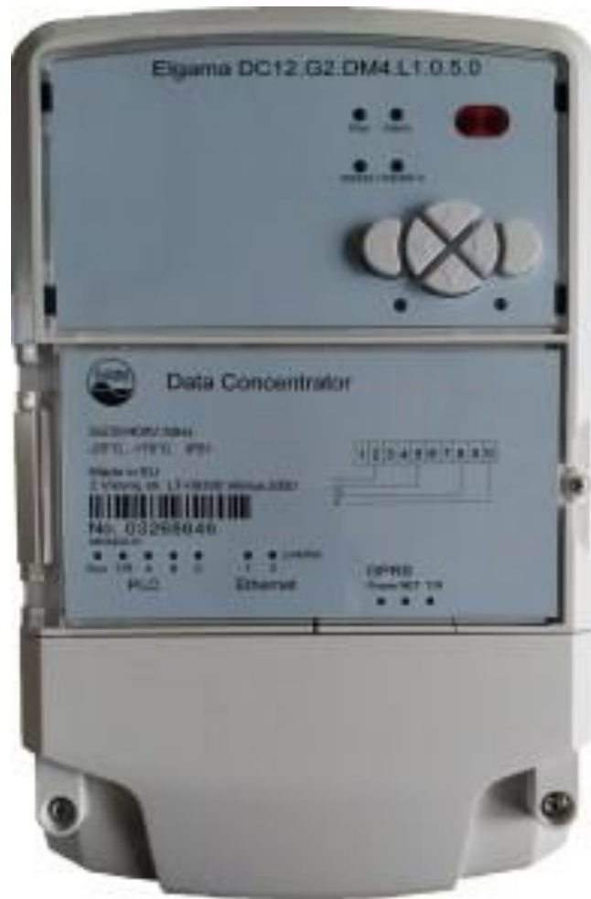
Рис. 2.4 - Контролер збирання даних з внутрішнім GSM/GPRS модемом DC-12.
