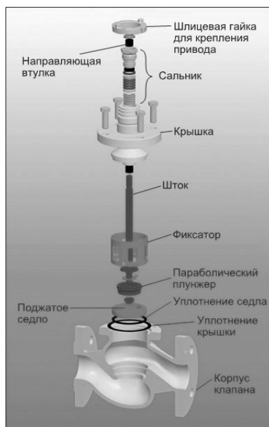
Рис. 3.7. Основні частини регулюючого клапана
