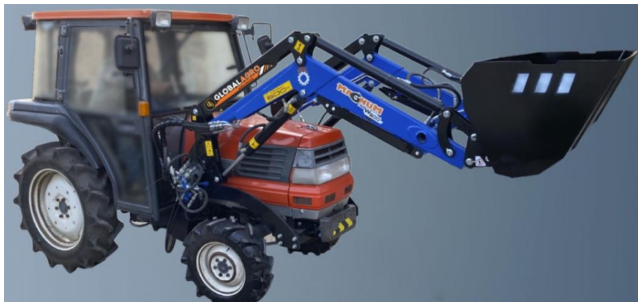
Рис. 2.4. Фронтальний навантажувач швидкоз'ємний КУН Magnum-W600 на мінітрактор Kubota-244.
