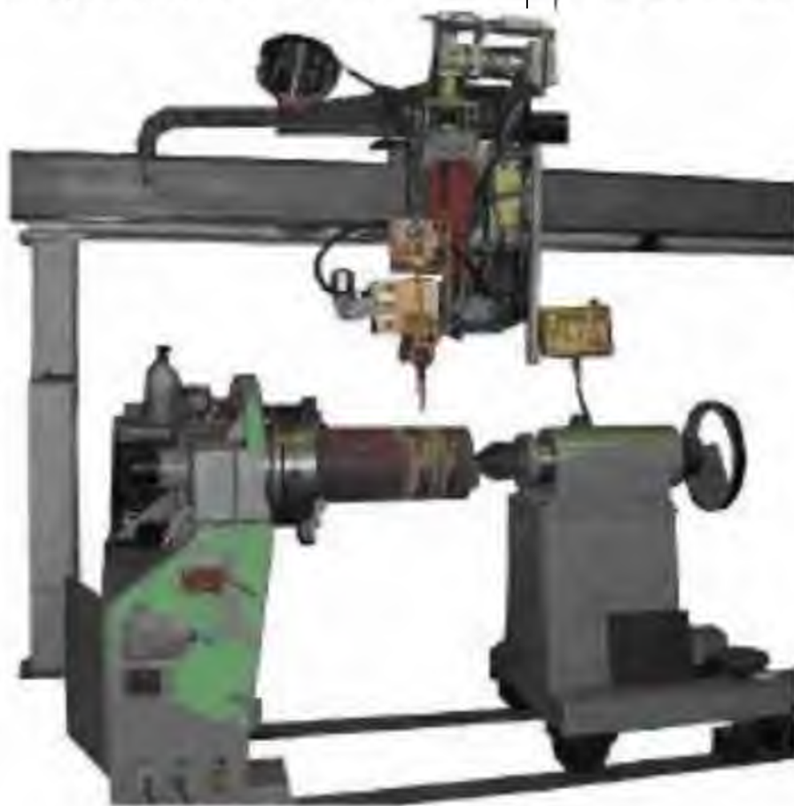
Рисунок 5.1 – Базування корпусу гідророзподільника під час обробки отворів методом ЕІН
