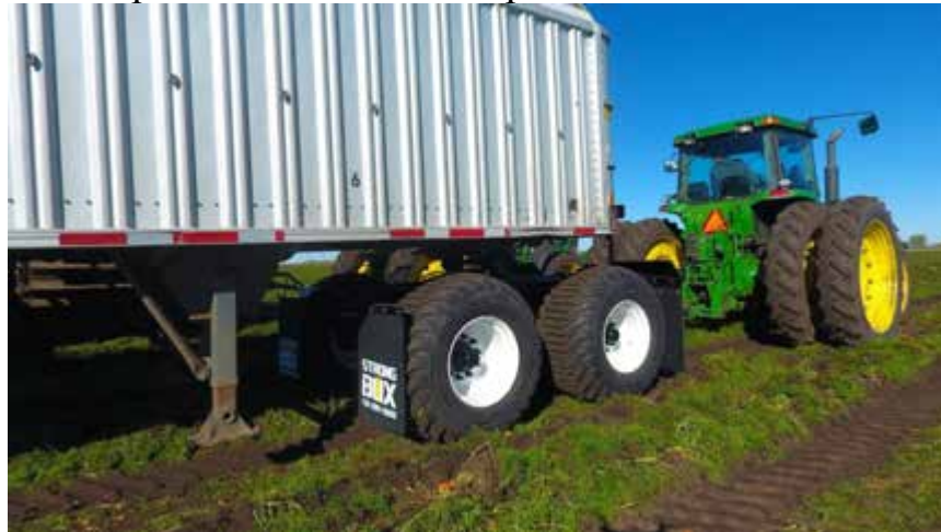
Рис. 1. Змінний напівпричіп-самоскид в агрегаті з трактором
