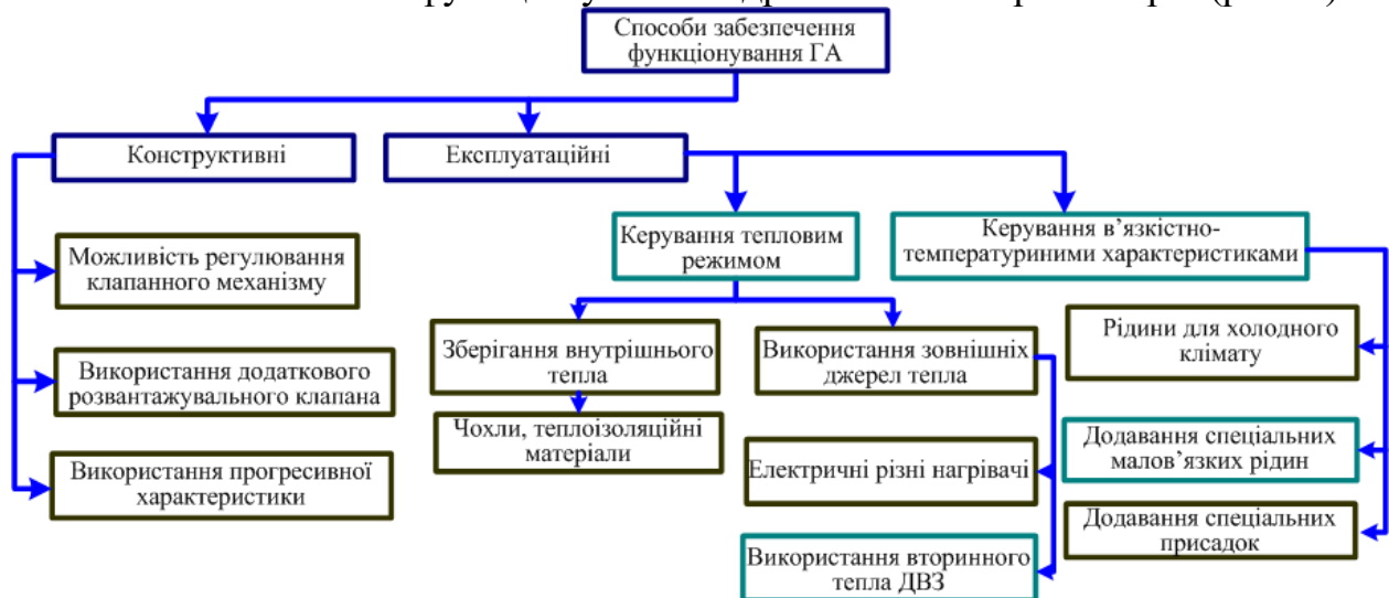
Рис. 1. Способи забезпечення функціонування гідравлічних амортизаторів автомобіля
