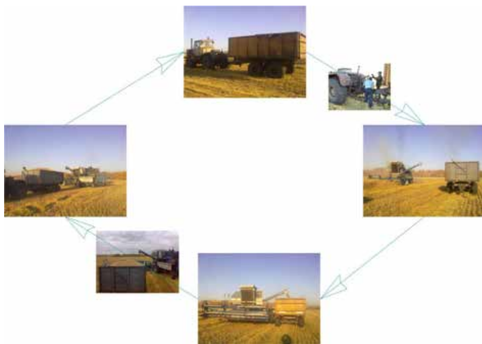
Рис. 1. Процес транспортного обслуговування оборотними причепами
