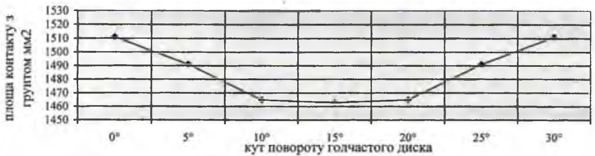
Рис. 3.1 Фаза входу в ґрунт голчастого диска та площа контакту при h = 73 \text{ мм}
