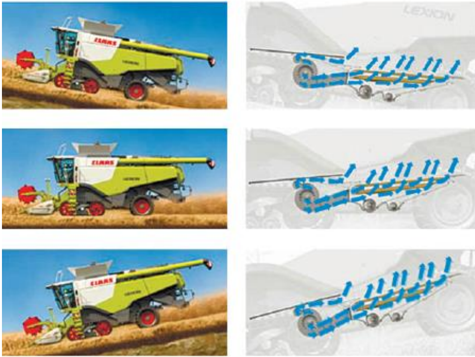
Рис. 3.4. Автоматичне регулювання потоку повітря від вентилятора під час руху комбайна на схилах
