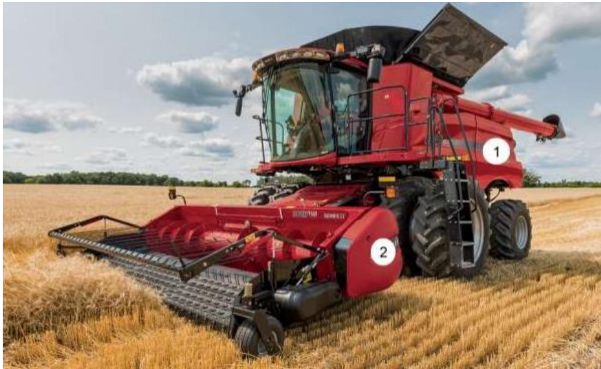
Рис. 1.3 - Підбирання та обмолот валків за роздільного способу збирання: 1 - зернозбиральний комбайн; 2 - підбирач
