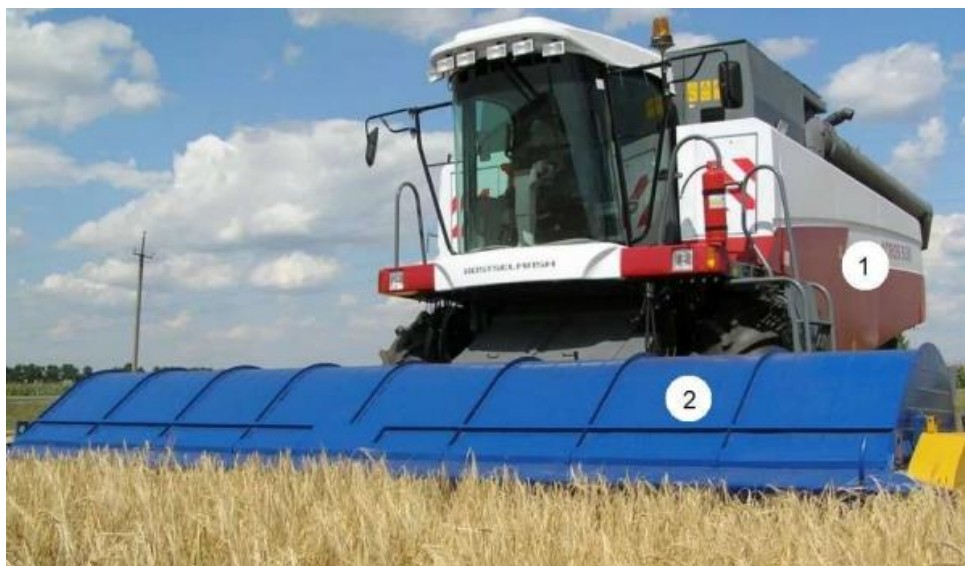
Рис. 1.6 - Загальний вигляд зернозбирального комбайна в агрегаті з обчісувальною жаткою "Слов'янка УАС": 1 - зернозбиральний комбайн; 2 - жниварка для вичісування
