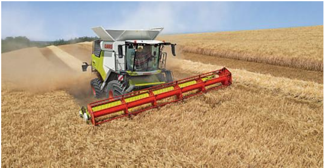
Рис. 3.7. Поперечне вирівнювання корпусу комбайна «Claas» на схилі
