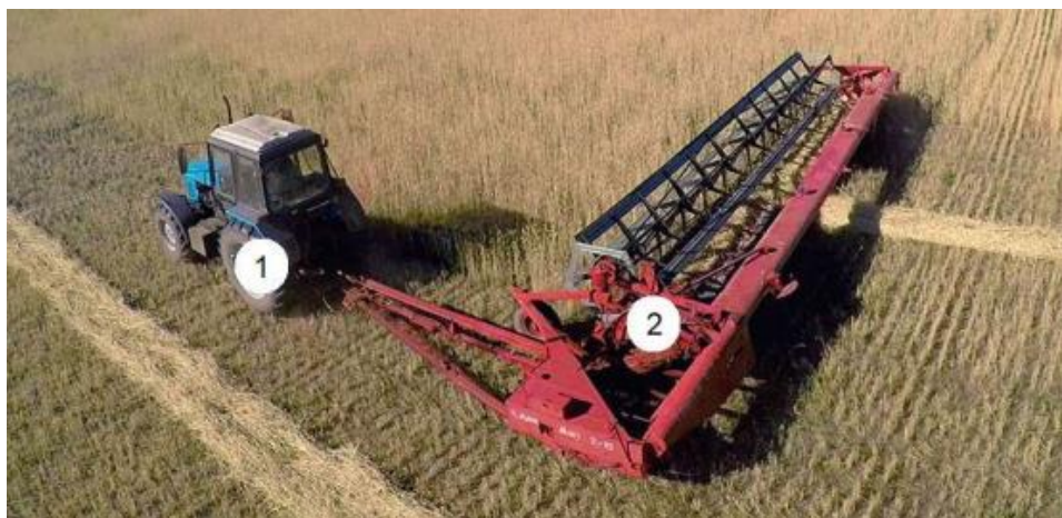
Рис. 1.2 – Скошування і укладання хлібів у валок при роздільному способі збирання: 1 – трактор; 2 – валкова жатка
