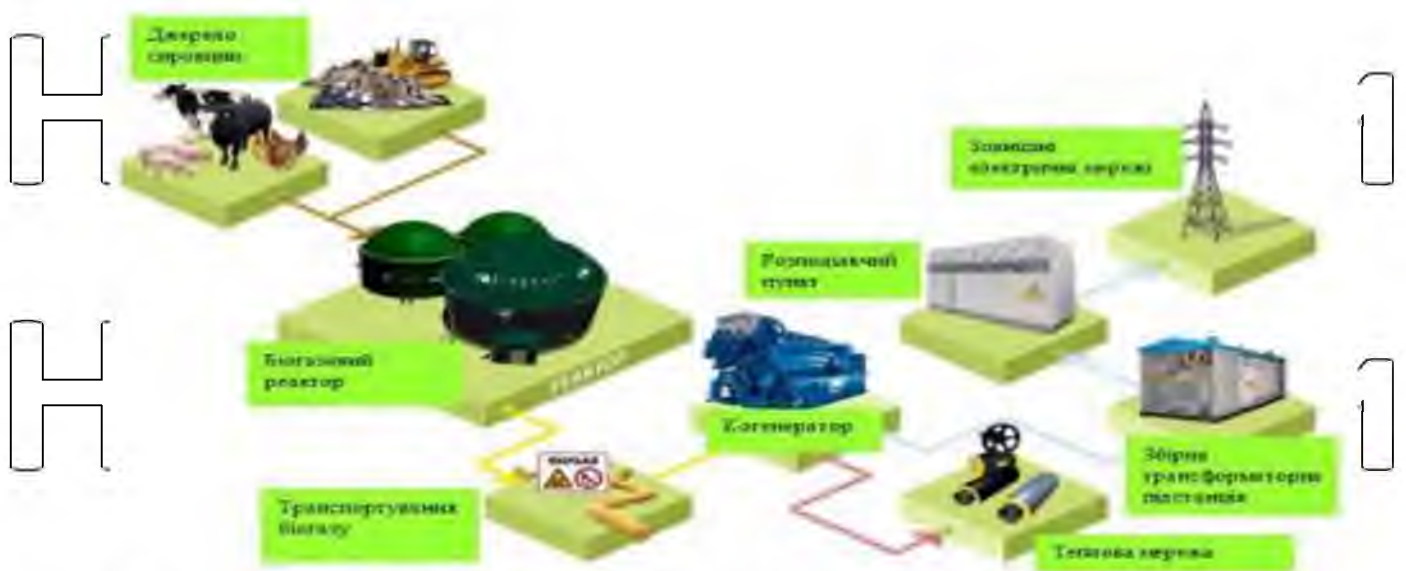
Рис. 1.6 Схеми роботи біогазової електростанції
