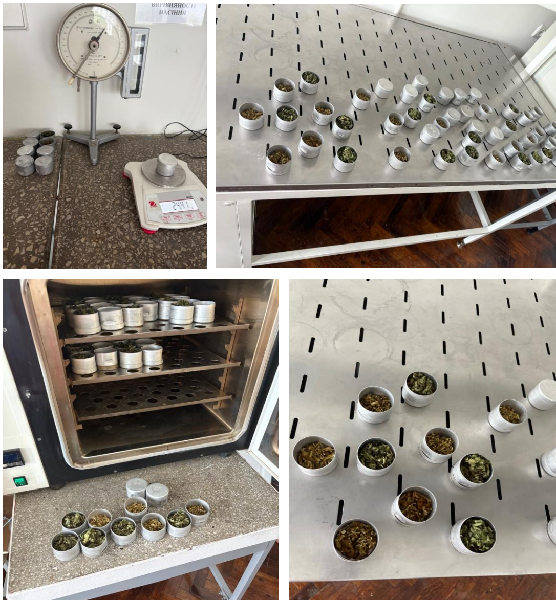
Рис. 17. Лабораторний аналіз - визначення сухої речовини
