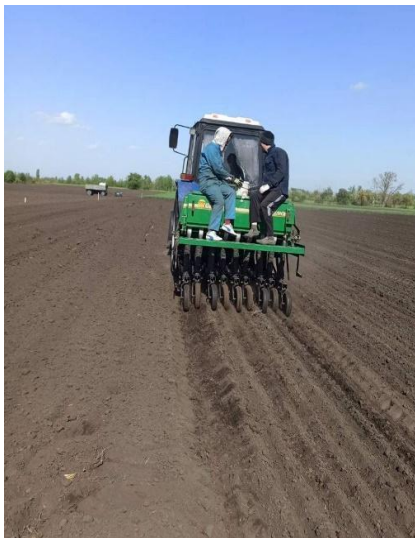
Рис. 5. Контроль посіву «на ходу» щоб уникнути забивання сошників та пропусків посіву у рядках
