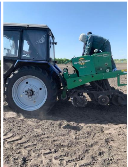
Рис. 5. Контроль посіву «на ходу» щоб уникнути забивання сошників та пропусків посіву у рядках
