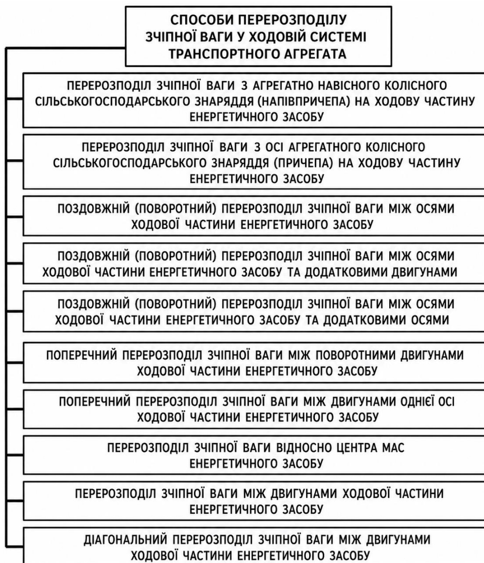
Рисунок 1.7 - Способи перерозподілу зчіпної ваги в ходовій системі транспортного агрегату
