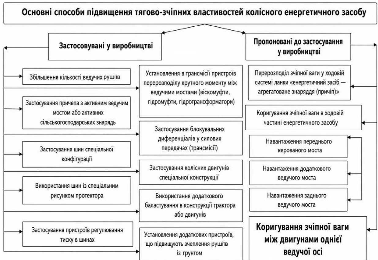
Рисунок 1.1 - Основні способи підвищення тягово-зчіпних властивостей колісного транспортного засобу, що використовуються та рекомендуються
