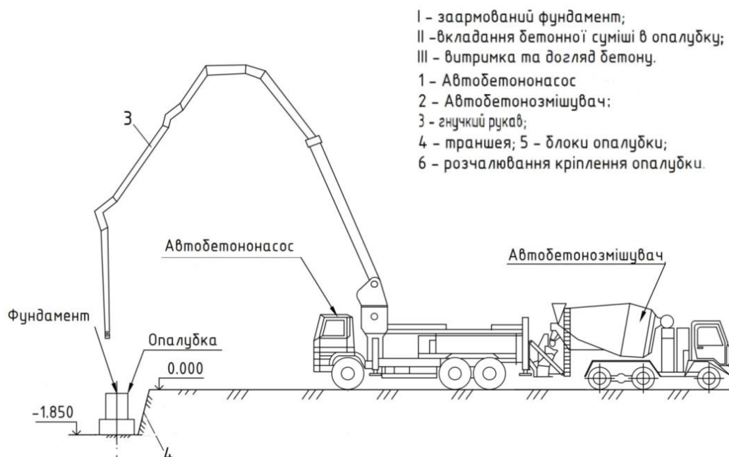
Рис. 4.3. Укладання бетонної суміші в готову опалубку
