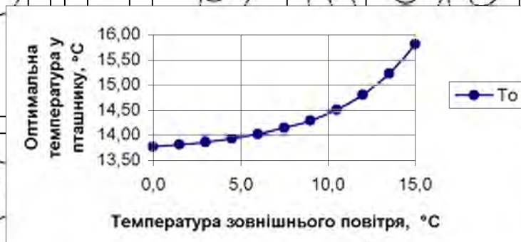
Рис. 2.5. Залежність оптимальних значень температури T_o у приміщенні промислового пташника від температури зовнішнього повітря T_z , при відносній вологості зовнішнього повітря V_z = 60\%
