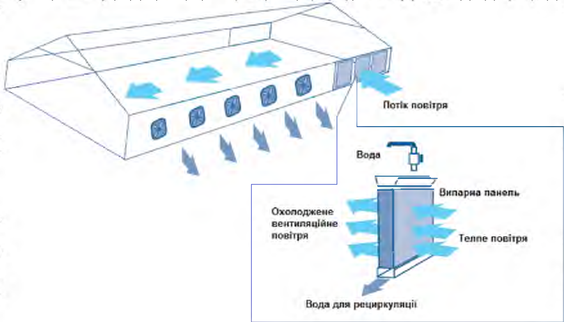
Рис. 1.7. Схема улаштування системи охолодження повітря у пташнику за допомогою випарних охолоджуючих панелей
