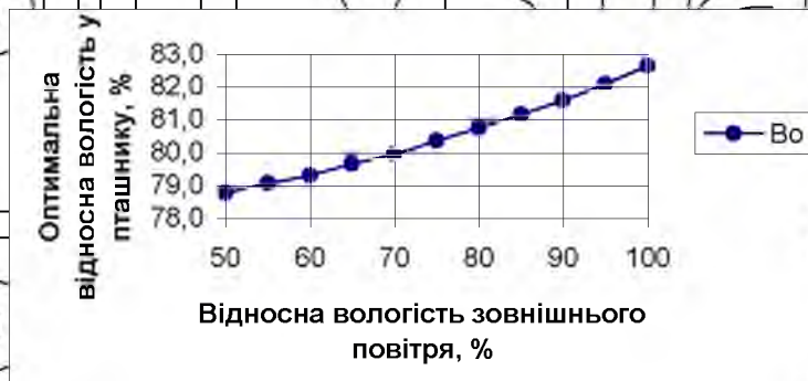
Рис. 2.4. Залежність оптимальних значень відносної вологості B_o у приміщенні промислового пташника від відносної вологості зовнішнього повітря V_z , при температурі зовнішнього повітря T_z = 6^\circ\text{C}
