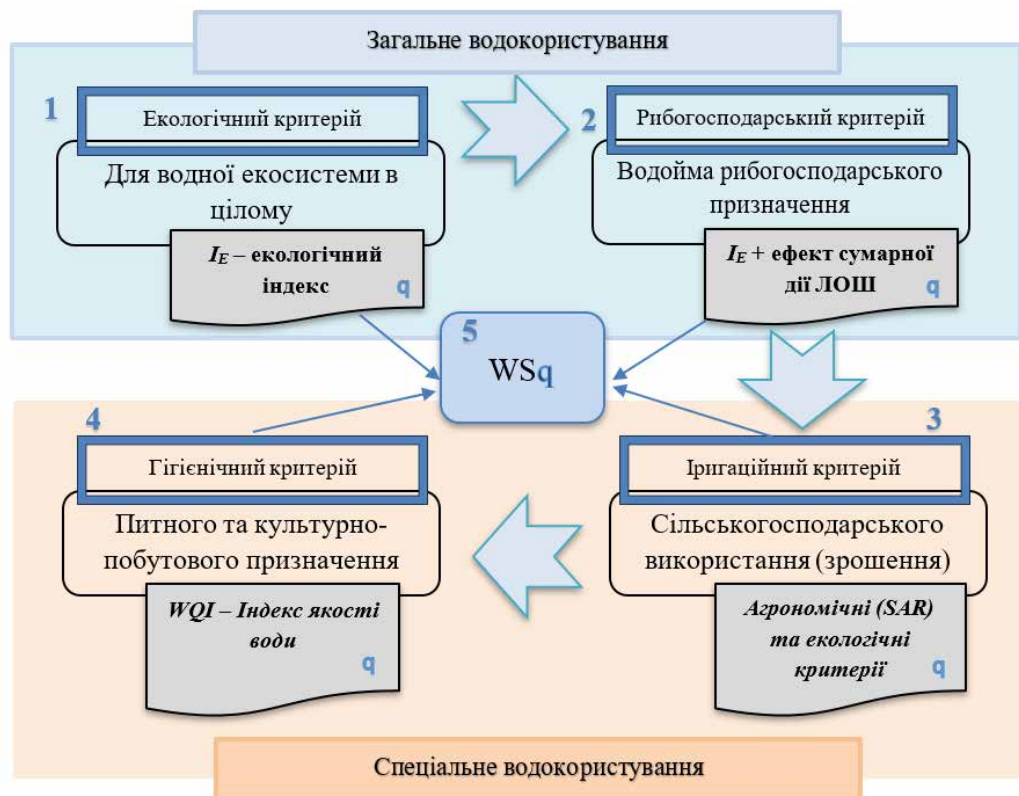
Рис. 3.1. Алгоритм інтегральної оцінки екологічного стану води Київського водосховища за критеріальним підходом для різних видів водокористування
